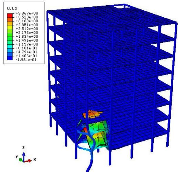
Fig. 23. Vertical displacement contour (case3)
