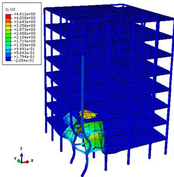
Fig. 26. Vertical displacement contour (case4)
